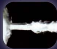
Распыление ЛКМ при рабочем давлении 2,0 бар
